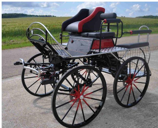
**VELOCE ELITE** : Voiture d'occasion révisée, pour cheval , brancards indépendants inox télescopiques, largeur de voie 125 cm, essieu réglable 125/138 cm, poids 200 kg, 4 freins à disque, siège meneur réglable au centre, dossiers arrière démontables .
